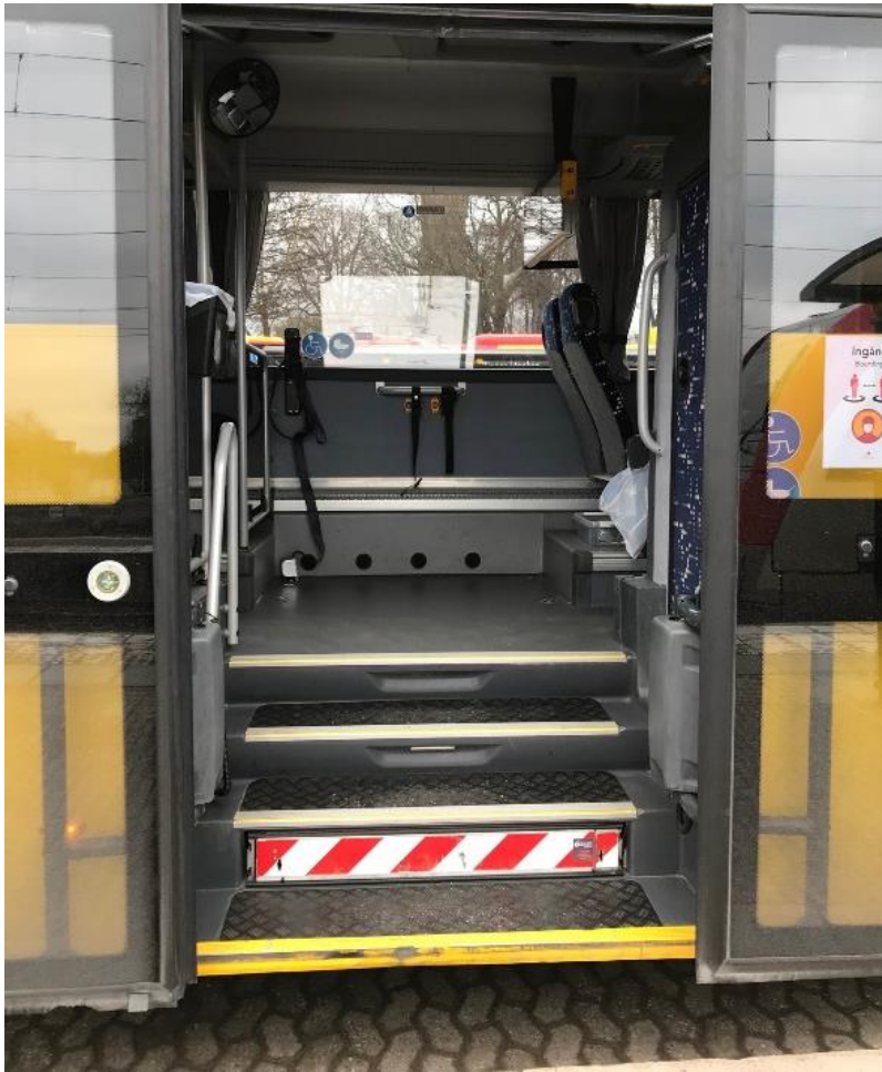
Figur 20. Bakre entré till höggolvsbuss. Notera att flexutrymmet är för kort för en cykel. Dörren är också ganska smal med tanke på det lyft som krävs.
