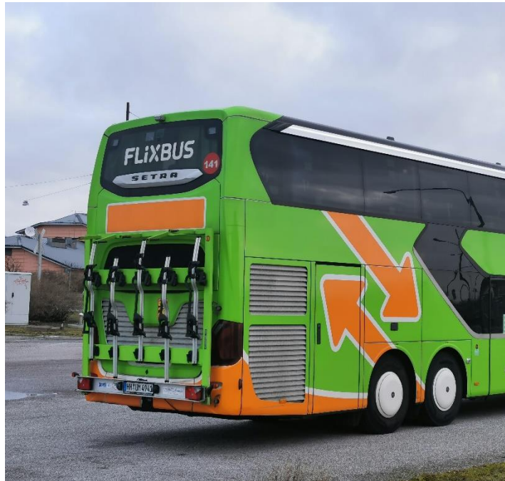
Figur 18. Exempel på en mer ambitiös karossmonterad cykelhållare som har plats för fem cyklar och som inte kräver att cyklarna sätts på och tas av i samma ordning. Notera att det inte är samma bussklass som regionbussar. Bakfönstret är högre upp. I denna variant hängs cyklarna stående, hängande i framhjulet.
