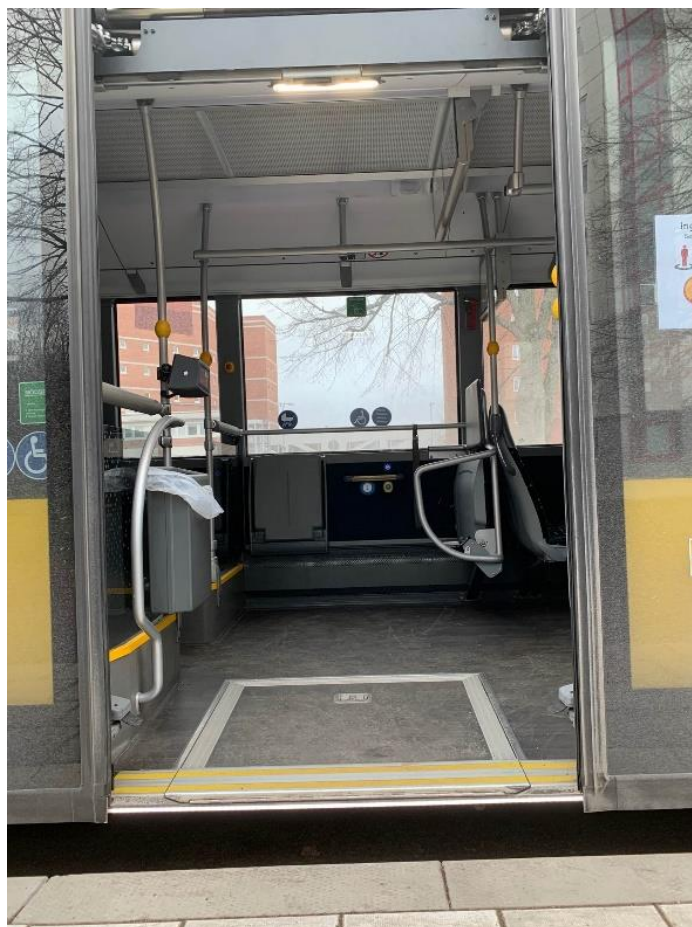
Figur 22. Bakre entrén och det ena flexutrymmet i en stadsbuss (låg golvsbuss). Notera att flexutrymmet är för litet för en cykel annat än att cykeln förvaras stående.
